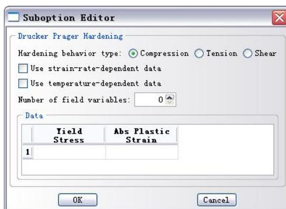
图 4-15 定义 Drucker-Prager 模型的硬化参数
