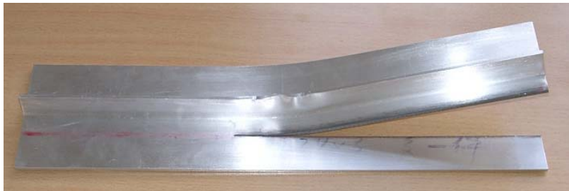
图 4.31 蒙皮部分切开后的压弯试件
