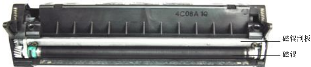
图 4-17 HP 6L 激光打印机磁辊
