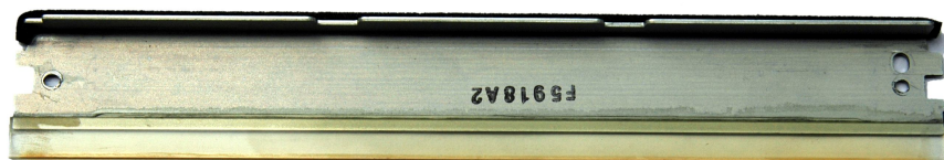
图 4-18 HP 6L 激光打印机的清洁刮板
