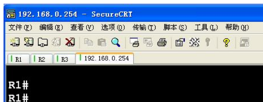
图 4-44 以 SSH 方式成功登录到路由器
