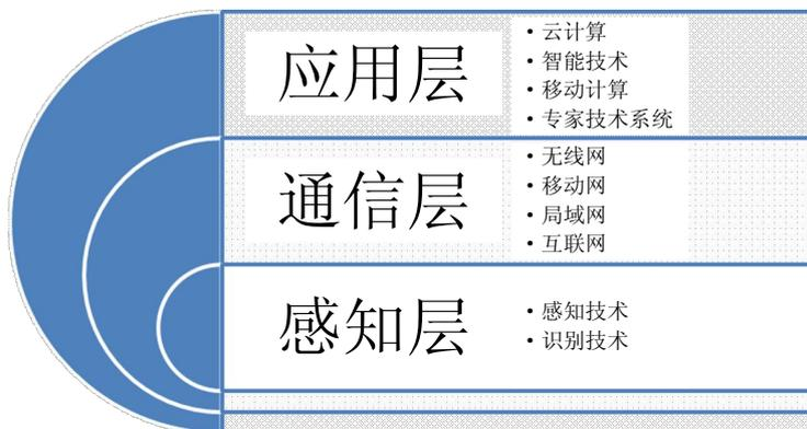
图 1.5 物联网 3 层架构
