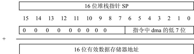
图 3-2 SP 作为基地址的直接寻址方式
