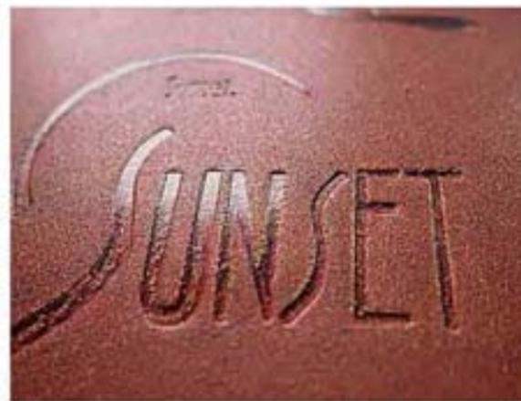
图1-61 磨砂UV配合压凹
