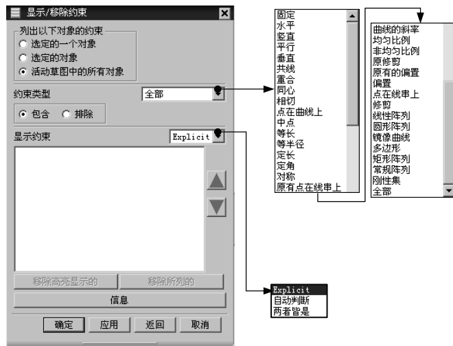
图 5.9.1 “显示/移除约束”对话框
