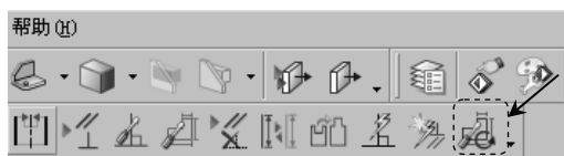
图 5.6.2 “连续自动标注尺寸”按钮
