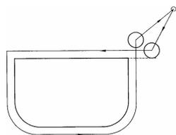
图 2.10.2 外轮廓铣削走刀路线
