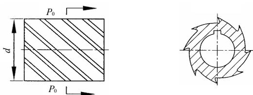
图 2.7.2 圆柱铣刀
