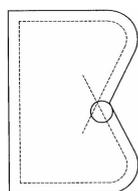
图 2.10.3 内轮廓铣削走刀路线
