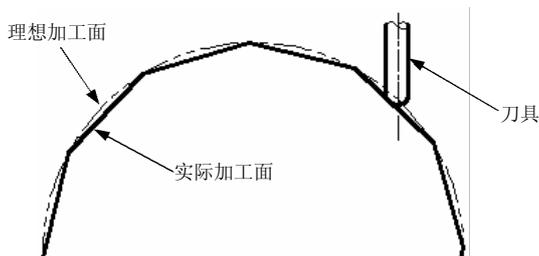
图 2.16.1 加工精度示意图
