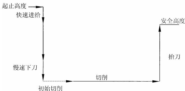
图 2.9.1 起止高度与安全高度示意图
