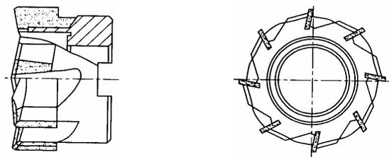
图 2.7.1 硬质合金整体焊接式面铣刀
