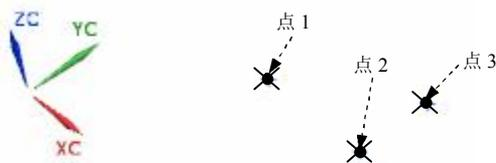
图 2.4.9 利用坐标值创建基准点
