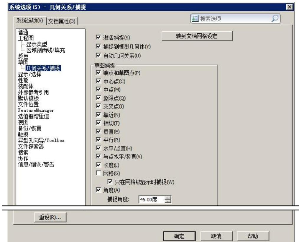
图 1.1.4 “系统选项 (S) - 几何关系/捕捉”对话框
