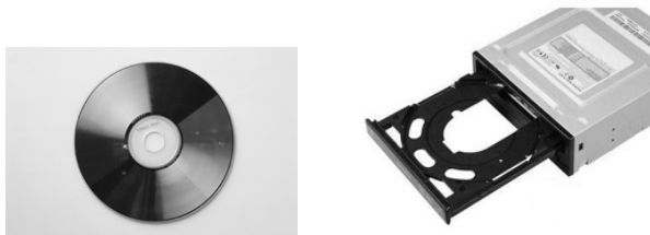
图 1-18 CD-ROM 光盘和光盘驱动器外形图
