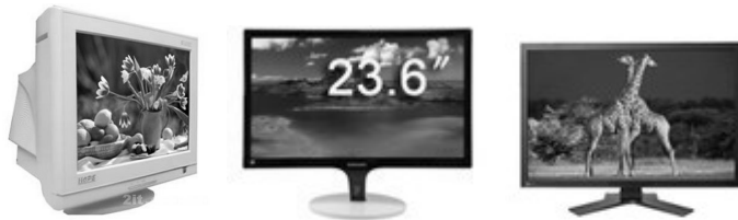
图 1-30 CRT 显示器、液晶显示器和等离子显示器
