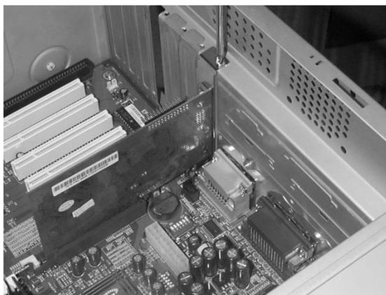
图 2-22 用螺丝固定显卡
