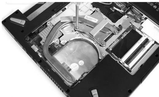
图 2-36 固定 CPU 散热部分的四颗螺丝
