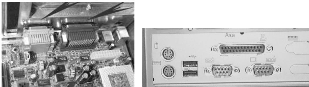
图 2-13 使主板的外设接口与机箱后面的孔位对齐
