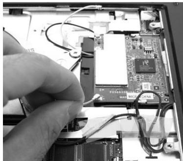
图 2-42 安装无线网卡天线
