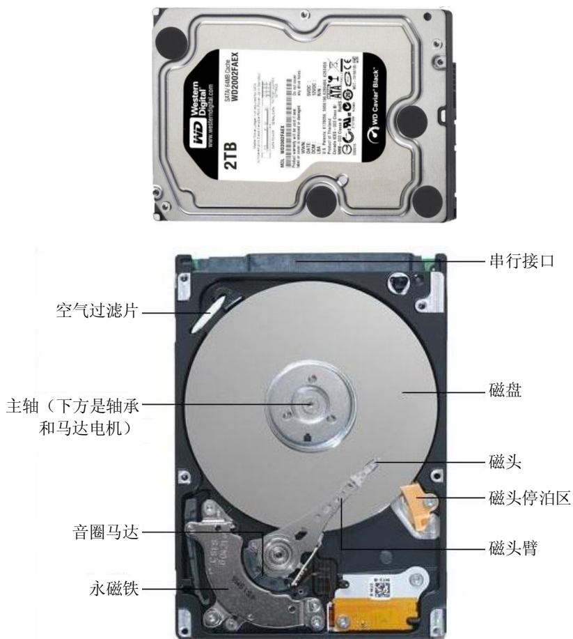
图 1-8 硬盘及其内部结构
