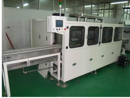
图 1-20 PLC 在电池清洗设备中的应用
