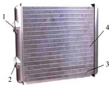
1—进水口；2—出水口；3—水管；4—散热片
