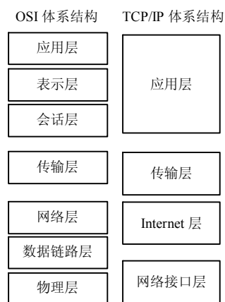
图 1-11 TCP/IP 体系结构
