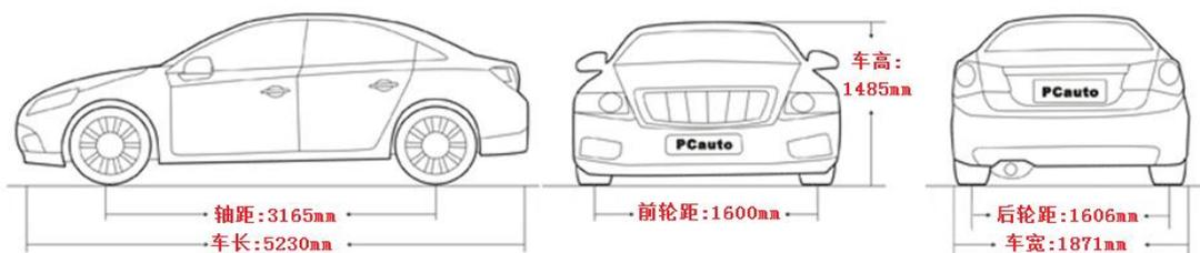
图 1-5 奔驰 S350L 轿车轮廓参数
