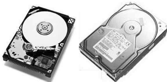
图 1-24 硬盘外观结构图
